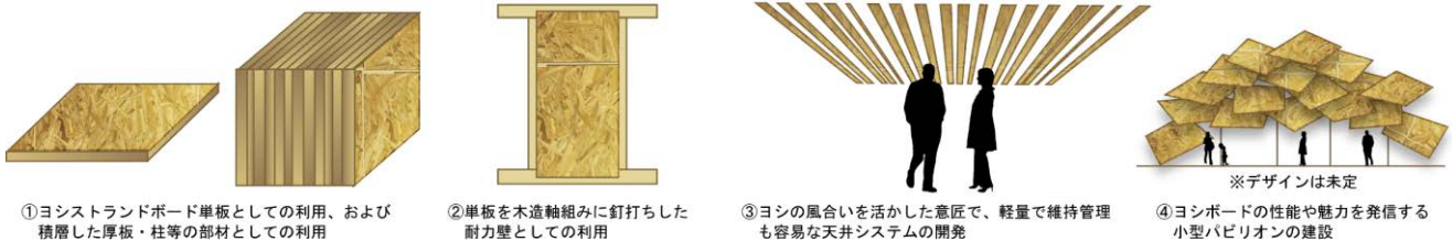
RSBの様々な用途のイメージ (いずれも基礎的な実験により実現の目途が立っています)
